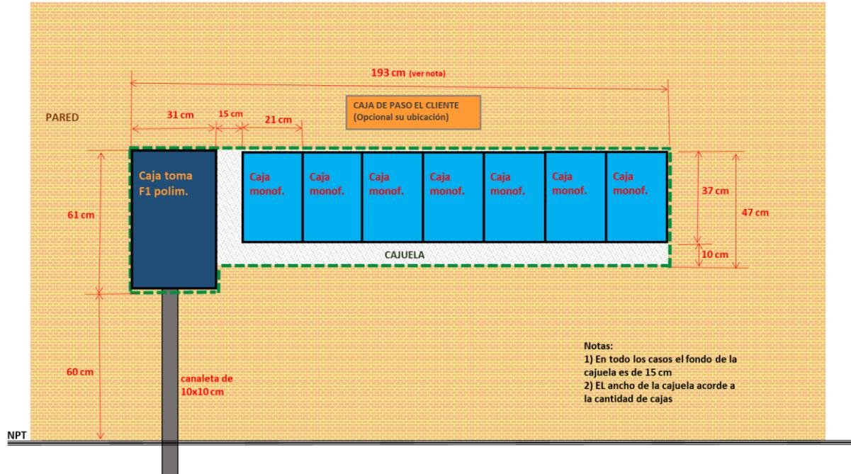
3) MODELO 3. Hasta 7 suministros trifásicos con una potencia de 3 a 19,9 6 kW c/u en dos filas. Cada banco estará compuesto por:
